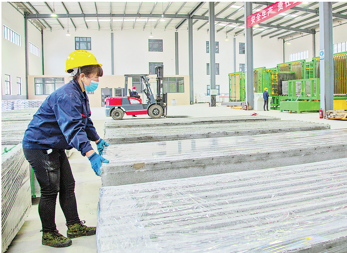
11月5日，在柞水县小岭镇工业产业园里，陕西贝恒节能建材有限公司工人正在对装配式墙板进行整理打包。该企业将尾矿资源生产加工成新型建筑材料，拥有多项自主知识产权，年可实现产值9800万元，实现税收850多万元。（记者 党率航 摄）
