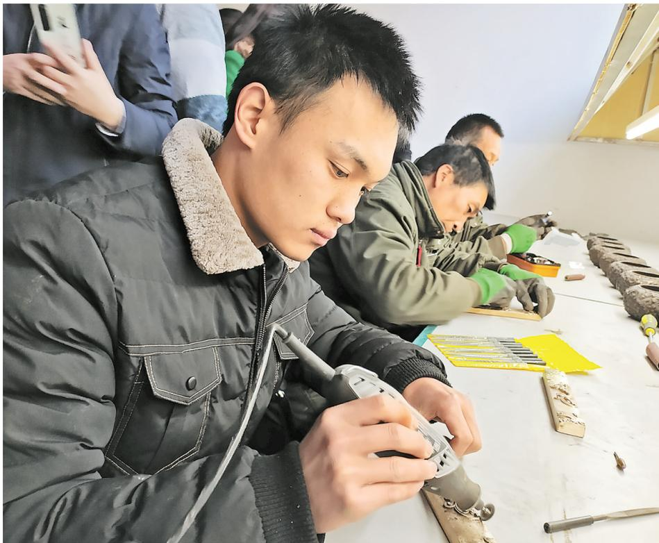
12月15日,在洛南县永丰镇洛铜艺术公司精修室,工人对铜雕制品进行打磨抛光修补处理。这是传统手工与现代工具相结合的一种精修处理工艺,也是高标准小件产品完工前最后一道流程,经过打磨抛光处理的产品纹理纹路颗粒清晰,立体感强,有较高的观赏和实用价值。(记者 贾书章 摄)
