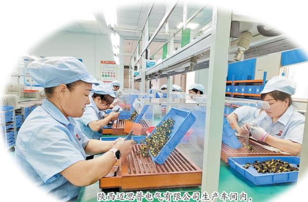
陕西迈思普电气有限公司生产车间内，工人正在生产制造高频变压器DC线材。
