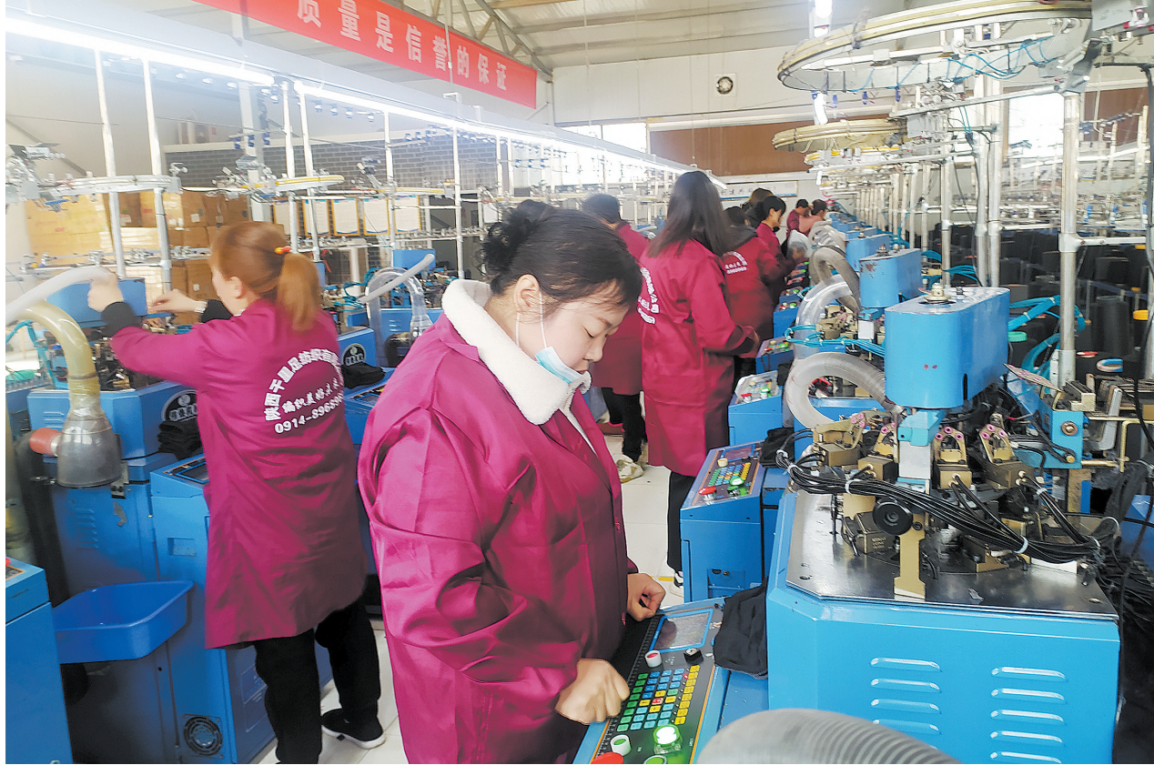
3月15日,在位于山阳县镇花镇的陕西千里足纺织有限公司织袜厂车间,工人们正在生产袜子。该公司成立于2021年,投资1000多万元,引进15条生产线共计211台设备,其中织袜机170台、定型机30台、缝头机11台,工厂月生产各种袜子300多万双,出口越南、菲律宾、印度等国家,年产值100万元。一期已安置当地100多人实现就业,其中脱贫家庭50多户,人均年收入3万至5万元。二期扩大规模后可解决当地200多户家庭就业困难。(本报记者 贾书章 摄)
